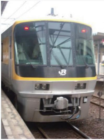
ふだん線路を通っている列車と同じくらいのスピードで走り、レールのじょうたいを調べ、きろくします。具体的には2本のレールのかんかくや左右のレールの高さ、レールのゆがみやねじれがないかをかくにんします。問題があれば中の測定機が異常を知らせてくれます。異常があった場合はしゅつりしてもらいます。きびしくチェックされしゅつりされた線路が、今日も安全な列車の運行をささえています。
